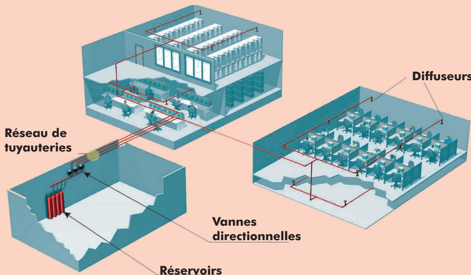
Le gaz IG-55 éteint un incendie en ramenant la concentration résiduelle en oxygène à un niveau ne permettant plus l'entretien de la combustion.
